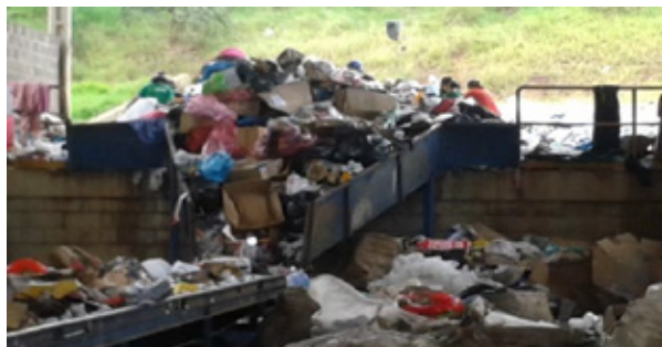
Foto – Detalhe de moega metálica de recepção de material a ser separado
