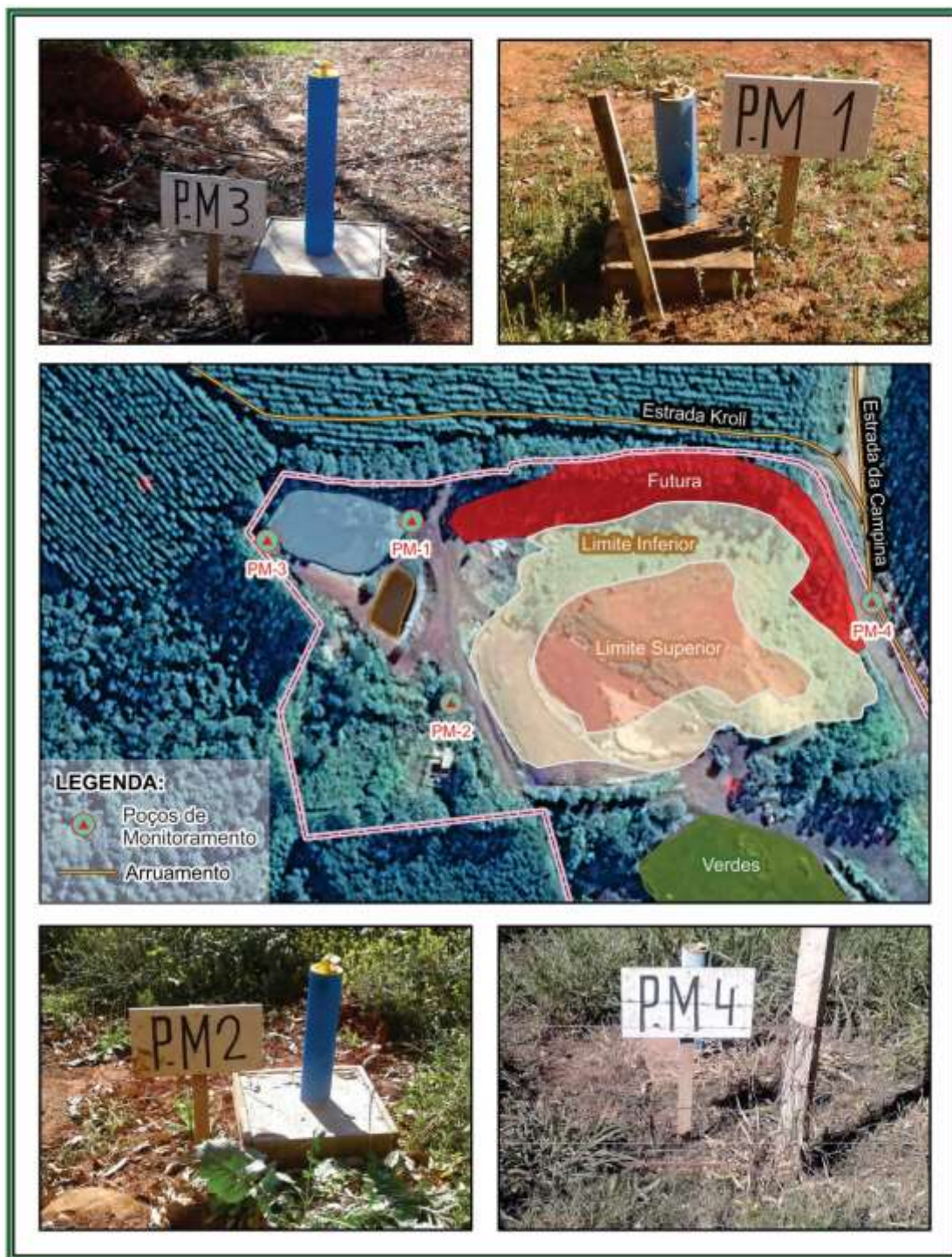
Figura 139: Poços de monitoramento do nível do lençol freático no aterro sanitário.
